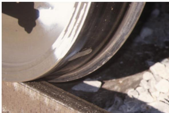
Fig. 1 Ruota con sfaccettatura di corda 15 mm
