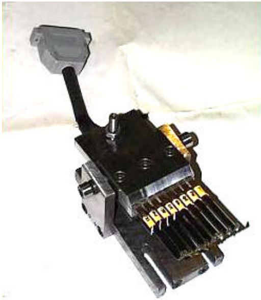
Fig.1-Attrezzatura per la mappatura della superficie di rotolamento delle ruote ferroviarie.
