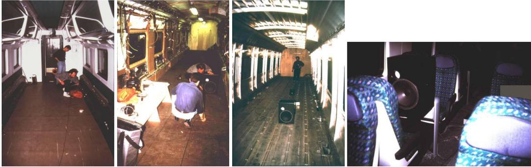
Figura 1 Viste della vettura dell'ETR500 durante le fasi di assemblaggio. Da sinistra verso destra: configurazione 1 (carrozza nuda, struttura in alluminio di lunghi estrusi saldati), configurazione 2 (pavimento ed elementi termoisolanti in vista), configurazione 3 (rivestimenti completi), configurazione 4 (vetture completa).
