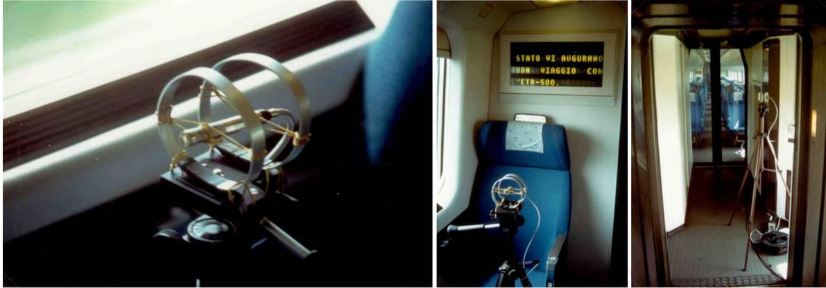
Figura 3. Rilevazione del campo di rumore interno all'ETR500. Microfono omnidirezionale con relativa sospensione (a sinistra), posizionamento nella zona passeggeri (al centro) e nella zona vestibolo (a destra).
