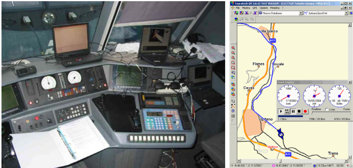
Figura 3. Cabina di guida della locomotiva (a sinistra); sono visibili i 3 PC di acquisizione, il ricevitore GPS Garmin V ed il roadbook compilato durante le corse prova. Track replay con indicazioni di velocità, tempo e altitudine (a destra).
