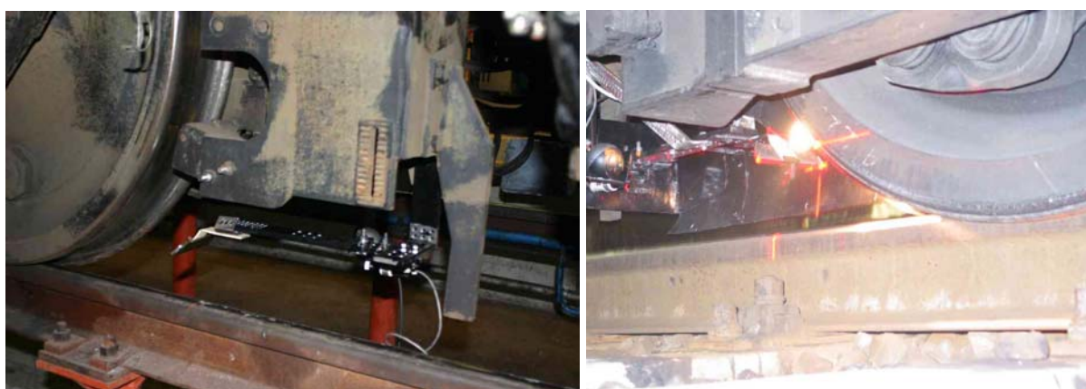
Figura 2. Montaggio parziale di una unità Ve.Lo.Co. WRIST in corrispondenza del supporto lanciasabbia – cacciapietre – ungiobordo (a sinistra) e vista durante le prove dell'unità installata davanti alla ruota destra del primo asse senso marcia (a destra)
