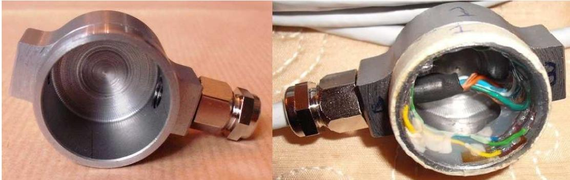
Figura 7: Bussola grezza e trasduttore ultimato.
