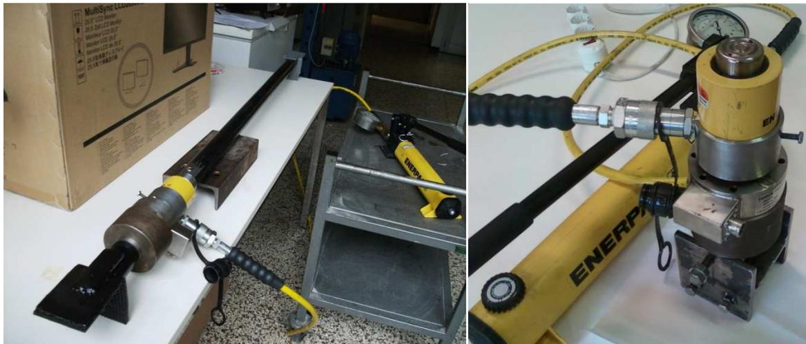
Figura 10. Apparecchiature di taratura per le catene di misura installate in linea per quanto concerne i carichi laterali (a sinistra) ed i carichi verticali (a destra, durante la fase di taratura con martinetto idraulico utilizzato sotto una struttura di contrasto, non illustrata).
