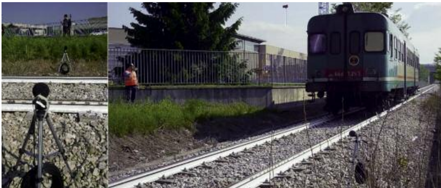
Figura 16 - PL km 2+956 della linea Bornato-Calino / Rovato (16.05.2019). A sinistra: posizionamento dei microfoni a fini investigativi (2.1 m dall'asse del binario, altezza 460 mm dal p.d.f. pari all'altezza dell'asse delle sale) e normativi (7.5 m dall'asse del binario ed 1.2 m dal p.d.f.) secondo EN ISO 3095. A destra: pass-by della ALn668.1053 ad 80 km/h (velocità prescritta dalla norma)
