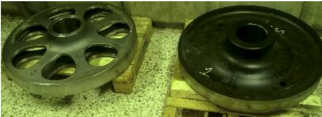
Figura 9 - Calettamento della Liberty Wheel strumentata da Italcertifer per il rilievo delle tensioni residue dopo il calettamento e particolare della ruota con gli estensimetri applicati (Nuova Comafer, Caivano (Na), 10.05.2019)
