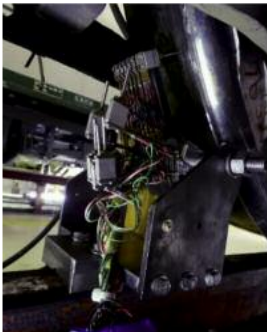
Figura 17 - Officine Trenord di Iseo (16.05.2019). Misura della rugosità delle ruote con strumento autocostruito (utilizzato anche per l'ETR1000) secondo prEN 15610. Le misure sono state effettuate al termine della campagna prove per ottenere superfici omogenee (eliminazione segni di tornitura anche mediante leggera frenatura costante durante le varie tratte)
