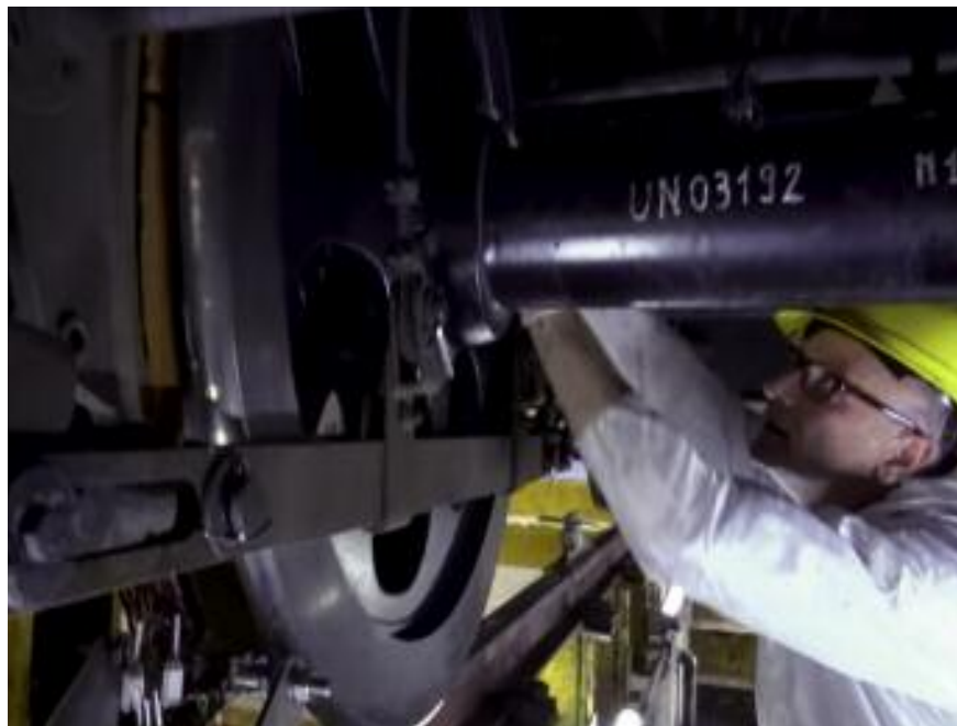
Figura 17 - Officine Trenord di Iseo (16.05.2019). Misura della rugosità delle ruote con strumento autocostruito (utilizzato anche per l'ETR1000) secondo prEN 15610. Le misure sono state effettuate al termine della campagna prove per ottenere superfici omogenee (eliminazione segni di tornitura anche mediante leggera frenatura costante durante le varie tratte)
