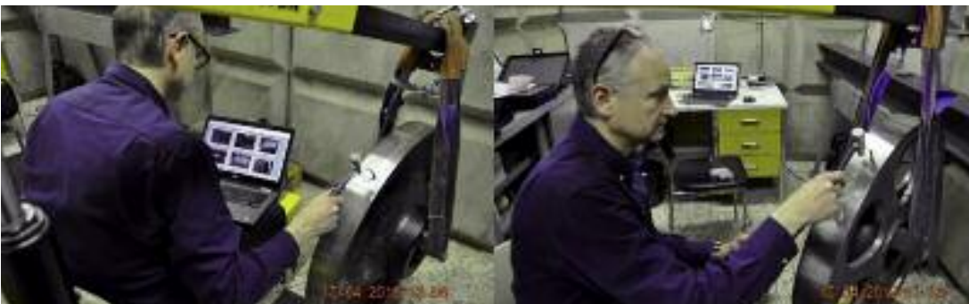
Figura 14 - Misure di mobilità meccanica per validare il modello FEM della Liberty Wheel e determinare il coefficiente di smorzamento dei modi propri fino a 5 kHz. A sinistra: centro ruota standard ALn668. A destra: centro ruota Liberty Wheel per ALn668 (laboratori UNIFI, 15.04.2019)
