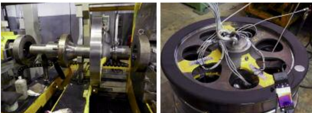
Figura 9 - Calettamento della Liberty Wheel strumentata da Italcertifer per il rilievo delle tensioni residue dopo il calettamento e particolare della ruota con gli estensimetri applicati (Nuova Comafer, Caivano (Na), 10.05.2019)
