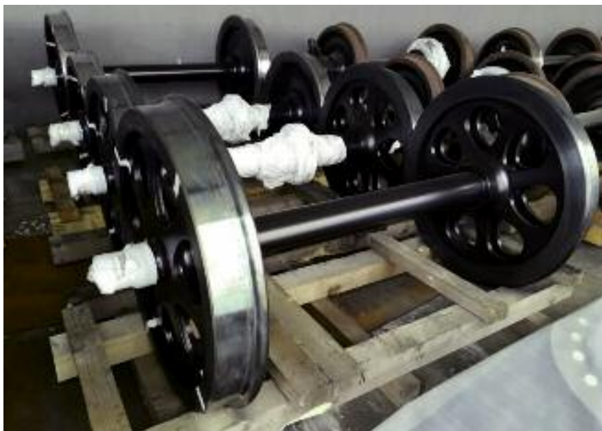
Figura 11 - Muta di sale per la ALn668.1053 pronta alla partenza da Caivano. Le due sale in primo piano sono equipaggiate con Liberty Wheels, quelle posteriori sono convenzionali. Tutte le ruote hanno la stessa rugosità iniziale
