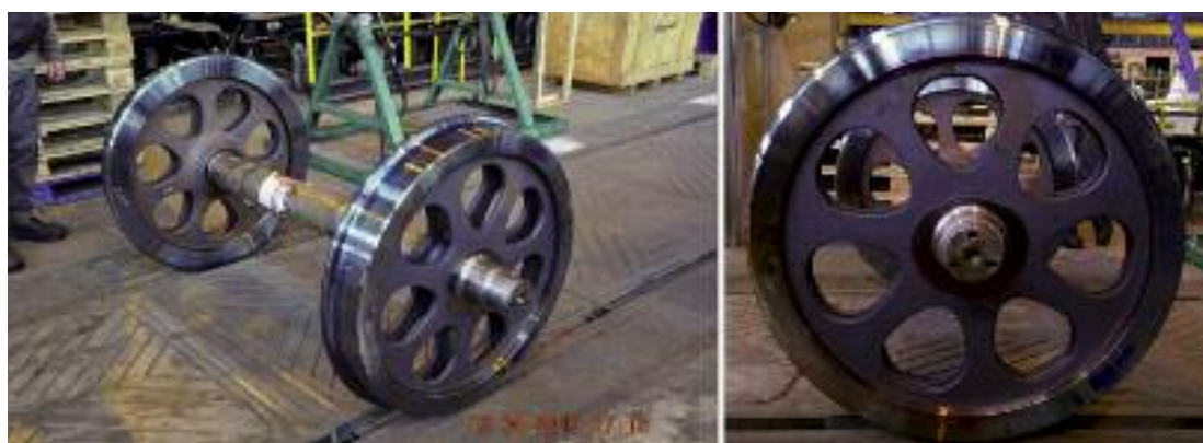
Figura 7 - Due viste della prima sala con ruote Liberty Wheels assemblate (16.04.2019)
