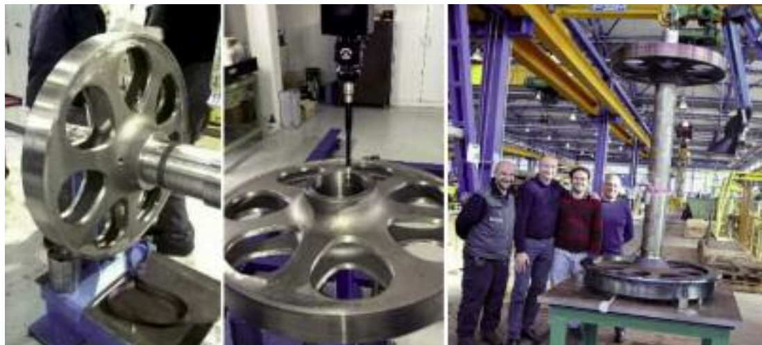
Figura 6 - Particolare durante il raffreddamento del cerchione. Ben in evidenza le due schiere di razze parallele che rendono unica la Liberty Wheel
