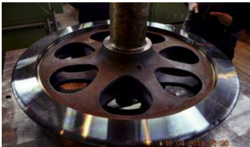
Figura 7 - Due viste della prima sala con ruote Liberty Wheels assemblate (16.04.2019)
