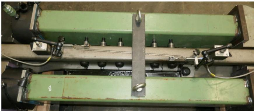
Figura 14 - Prova di trazione sul giunto ABJ\_007. Due trasduttori di spostamento sono posizionati per la misura dell'allungamento residuo al termine della prova che è definito nelle varie normative.
