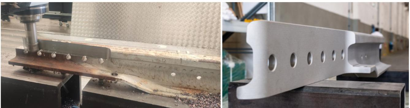
Figura 7 - Fresatura della barra per ago (sinistra), barra per ago lavorata e sabbata in fase di montaggio (destra). I due fori sull’anima della rotaia 60E1 servono per il collegamento dei cavi della corrente di ritorno verso le connessioni induttive. Tali cavi sono mostrati a scopo illustrativo in Fig. 6.
